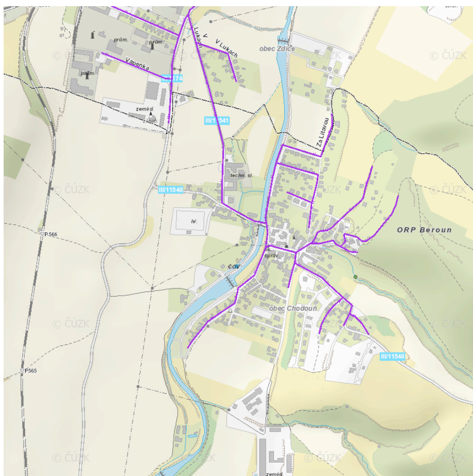
obr.: kanalizační síť v obci Chodouň (oddílná splašková kanalizace)
